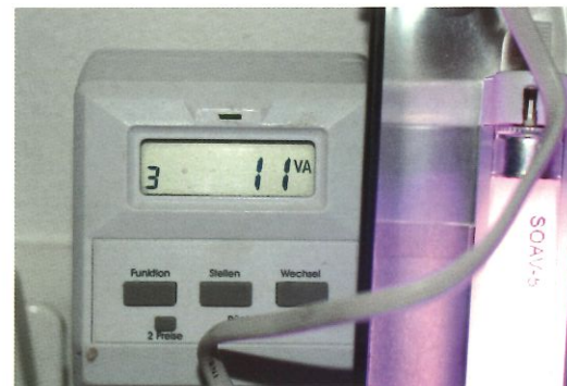
Bei dieser Leuchtstoffröhre (8 Watt/h) wird durch das elektronische Vorschaltgerät (EVG) der Stromverbrauch nur geringfügig erhöht. Messungen zeigen, dass eine 36-Watt-Leuchtstoffröhre mit EVG nur 38 Watt/h verbraucht.
